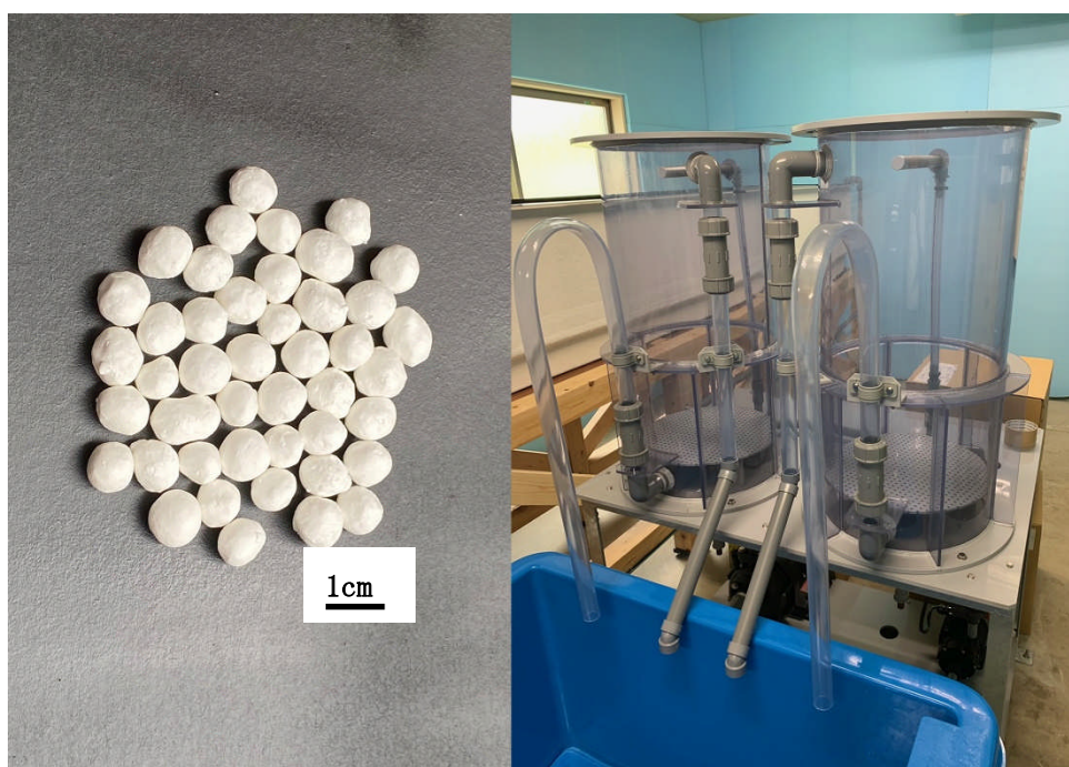
左：セルロース基質、右：間欠ろ過式好気脱窒装置（閉鎖循環式アワビ養殖施設）
